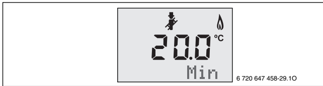
Fig. 43 Parpadea Min (= Potencia térmica nominal mínima)
