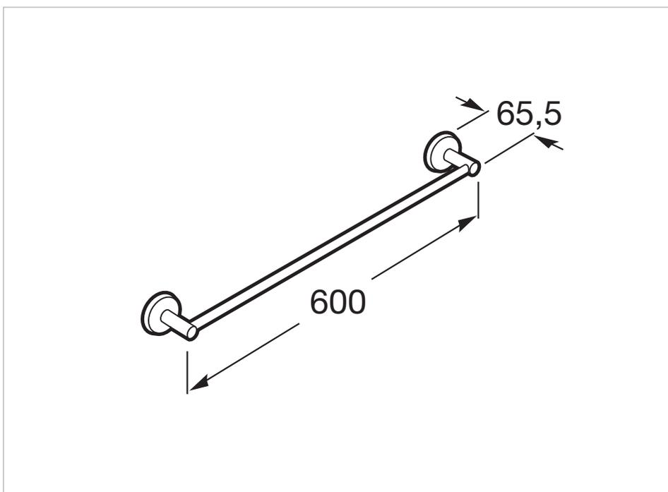
Twin es una colección de accesorios con diseño neutro y funcional. Además de la instalación con tornillería, Twin también permite una fijación alternativa mediante adhesivo, evitando así los agujeros y garantizando una alta resistencia (hasta 5 kg. de carga estática).
