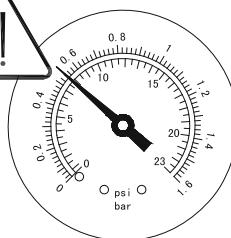
**NAPOMENA:** Mjerač pritiska koji se koristi isključivo prilikom održavanja uređaja očitava približne vrijednosti tlaka te se stoga ne smije koristiti kao uređaj za precizno mjerjenje razine tlaka.
