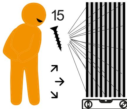
Mit Schrauben oder Kleber werden die Akustikplatten an der Wand montiert. Bei Montage an der Decke müssen immer Schrauben verwendet werden.
