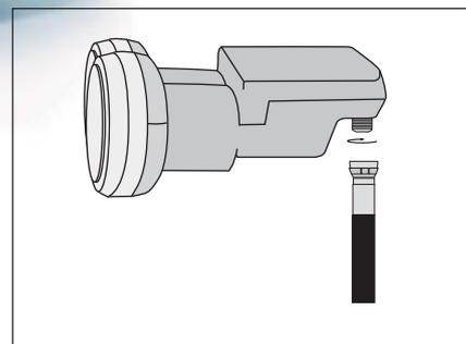
Sirve para recibir todos los programas de satélites Astra™19° y Hotbird™13° en un TV provisto de receptor digital y / o analógico, reemplazando sólo el LNB original de la parabólica. Sirve para los receptores analógicos con frecuencia de entrada comprendida entre 920 y 2150 MHz y generando una señal 22 kHz y DiSEqC\* TONE BURST/1.0. Sirve también para todos los receptores digitales. Este LNB es compatible con todas las marcas de terminales y de parabólicas (diámetro de fijación 40mm)
