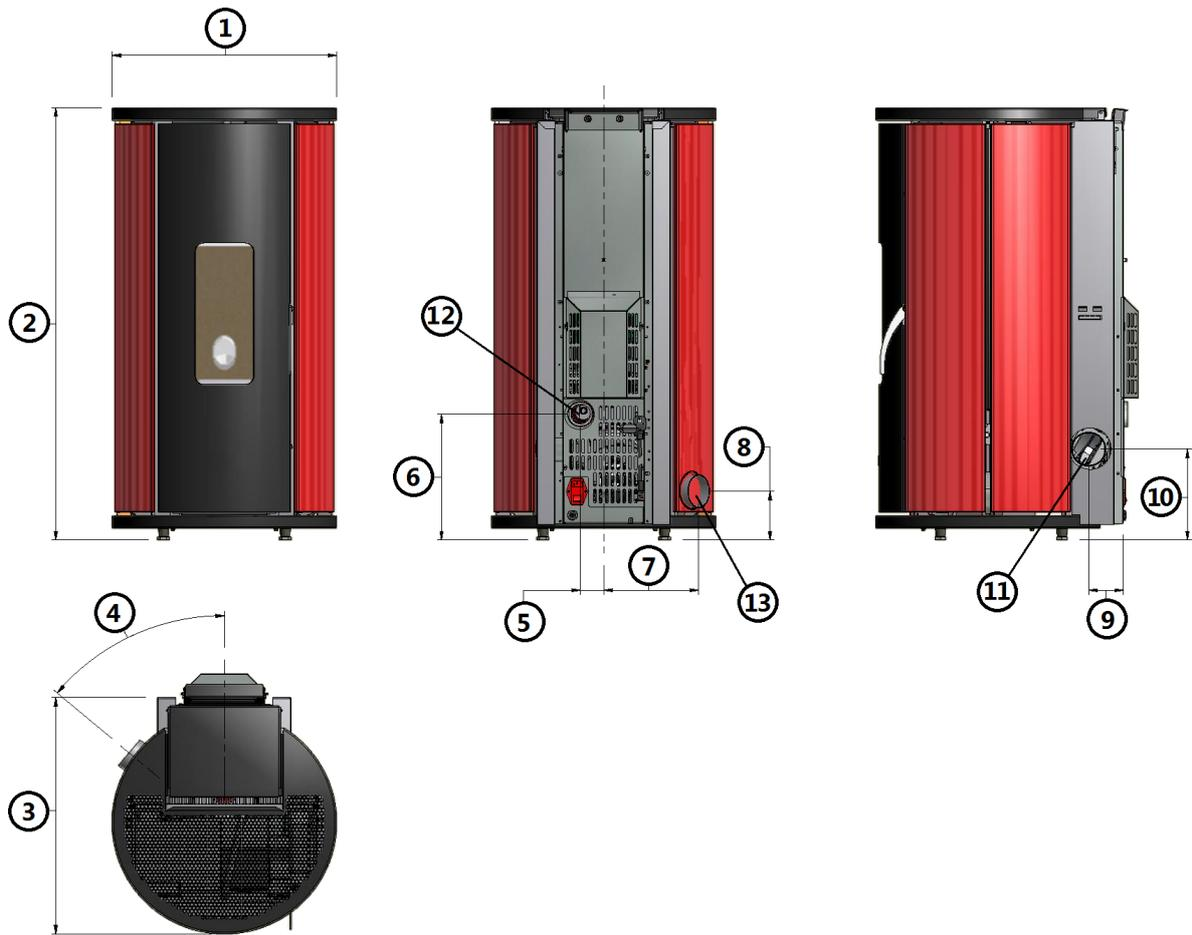
Fig. 17 - Dimensiones generales: Sfera<sup>3</sup> / Sfera<sup>3</sup> Plus / Globe
