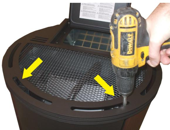
Fig. 62 - Extracción de los tornillos de la tapa 1
