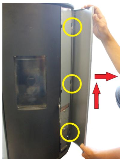
Fig. 61 - Sfera<sup>3</sup> / Sfera<sup>3</sup> Plus: desenganche los paneles laterales.
