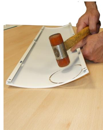
Fig. 29 - Abrir el orificio (modelo Sfera<sup>3</sup> Plus)
