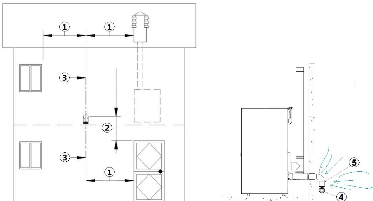
Fig. 7 - Toma de aire en caso de instalación estanca
