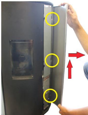
Fig. 27 - Ensamblaje paneles
