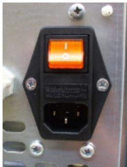
**Fig. 38 - Toma de corriente con interruptor general**
