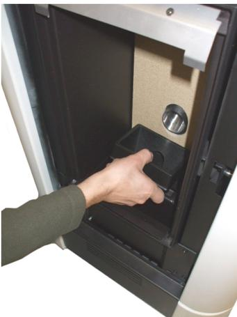
Fig. 50 - Extracción del brasero
