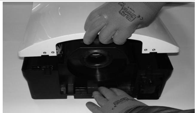
Desatornille los tornillos de fijación de la tapa circuito. Use un destornillador de punta PZ2.
