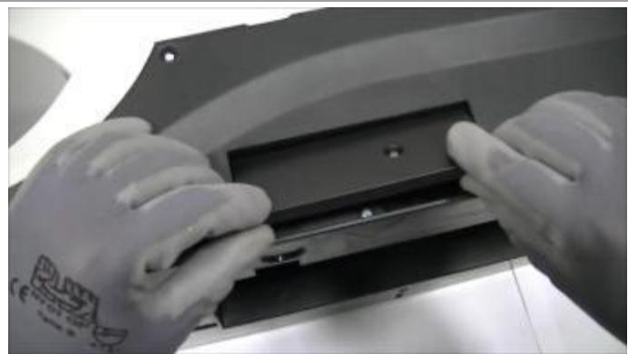
Utilizando un destornillador de punta plana gire el potenciómetro en sentido anti horario para disminuir la potencia del motor.
