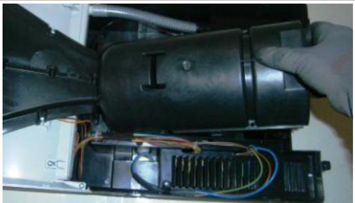
Desconecte los cables de alimentación del motor presionando el clip de seguridad del conector y tirando del conector suavemente.
