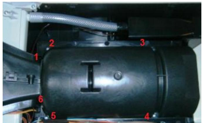
Mediante un suave pero firme tirón separe la tapa motor de la base.
