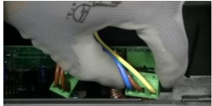
Desconecte los cables de sensor de nivel, sensores infrarrojos y pantalla led.
