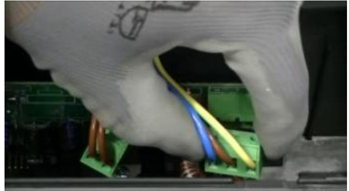
Corte la brida de sujeción de los cables de motor y alimentación.
