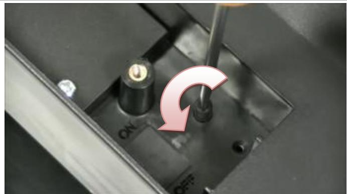
Gire el eje del potenciómetro en sentido horario para aumentar la potencia del motor.
