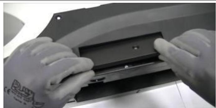
Retire el eje del potenciómetro.
