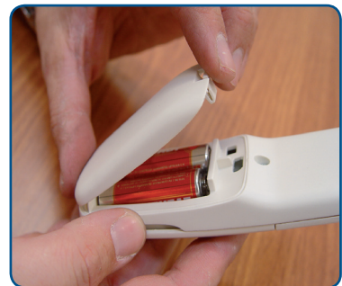
Abb. 4.1: Batteriewechsel bei den Außenbefehlsgebern
